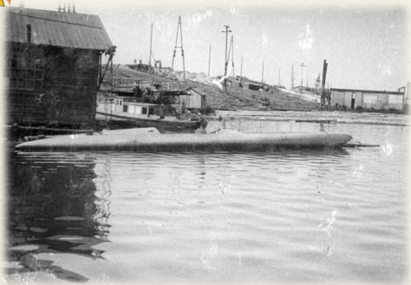
Спуск на воду катера на малопогруженных подводных крыльях А-4 (конструктор Р.Е. Алексеев) в гавани завода «Красное Сормово», 1943 год
